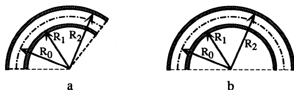
Fig. III.1-2. Analyseurs cylindrique (a) et hémisphérique (b). Le rayon R_0 représente le parcours idéal du faisceau.
